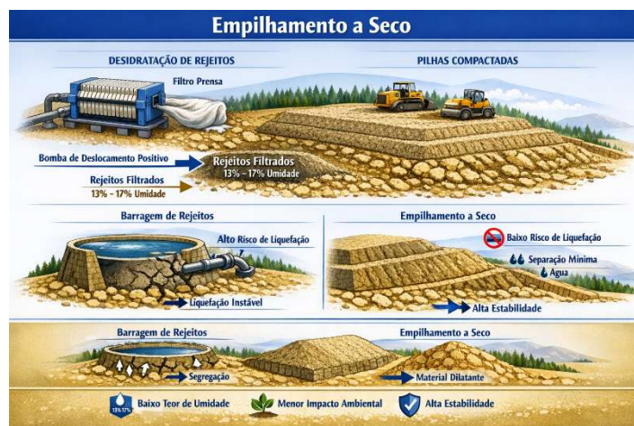
Figura 3 - Ilustração da técnica Dry Stacking
