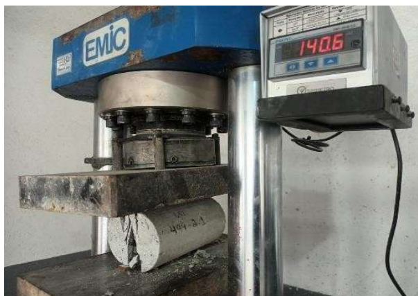
Figura 6: Ensaio de resistência à tração por compressão diametral em concreto. Fonte: Autor do Trabalho.
