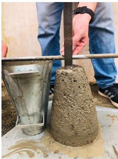
Figura 4: Ensaio de abatimento do tronco de cone em concreto com fibra de coco. Fonte: Autor do Trabalho.
