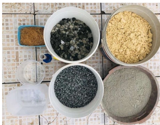
Figura 2: Materiais utilizados na execução do concreto. Fonte: Autor do Trabalho.
