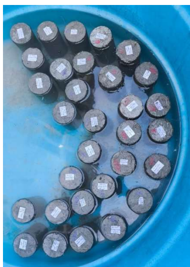
Figura 5: Corpos de prova de concreto submetidos à cura por imersão. Fonte: Autor do Trabalho.
