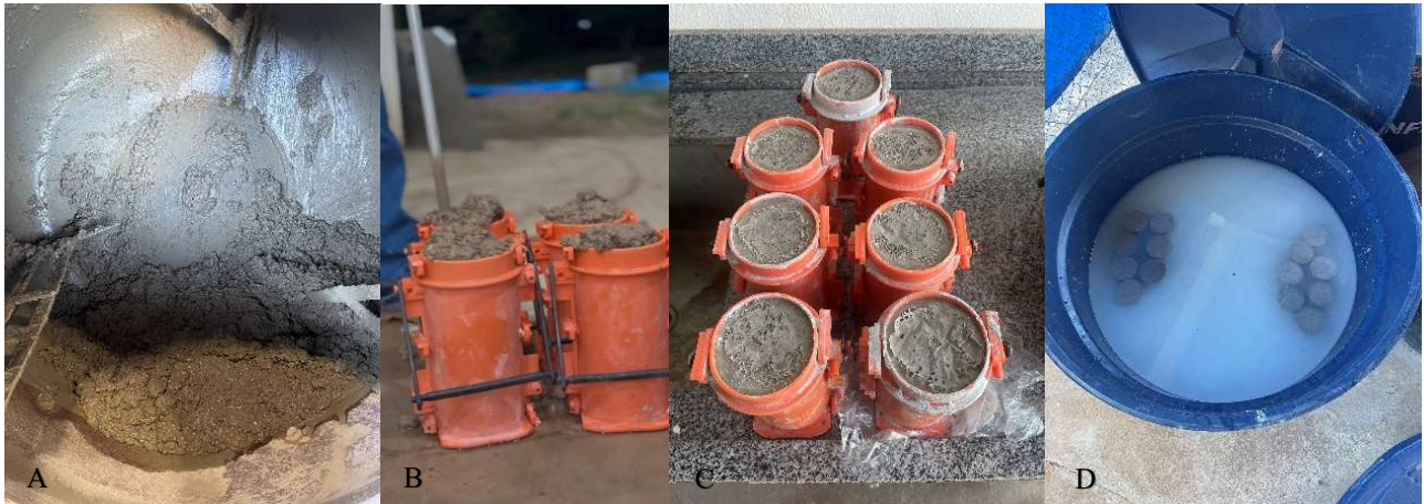
Figura 4: Dosagem (A), moldagem (B e C) e cura dos CP's (D). Fonte: Autor do Trabalho.
