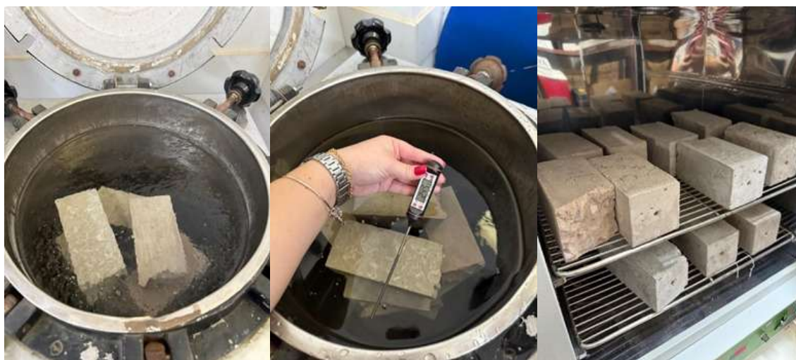
Figura 3: Ensaio de massa específica e absorção de água. Fonte: Autor do Trabalho.
