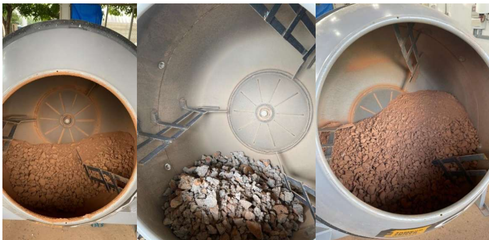
Figura 2: Britagem em Betoneira. Fonte: Integrantes do projeto.
