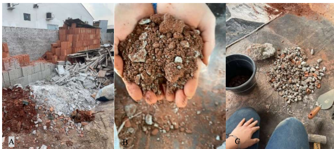
Figura 1: Triagem, classificação dos resíduos (A e B) e Pré-britagem manual (C). Fonte: Integrantes do projeto.
