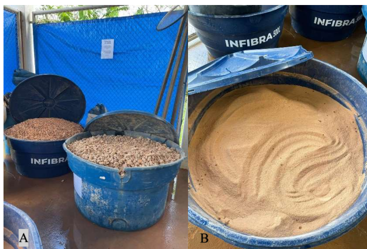
Figura 3: Rendimento do agregado graúdo (A) e agregado miúdo (B). Fonte: Integrantes do projeto.
