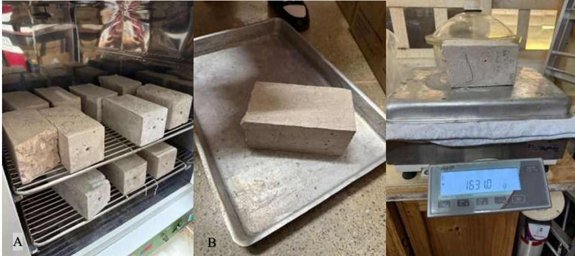
Figura 4: Corpos de provas utilizados (a); corpos de provas já quebrados ao meio para o teste (b); primeira pesagem dos corpos de provas (c). Fotos: Integrantes do projeto.
