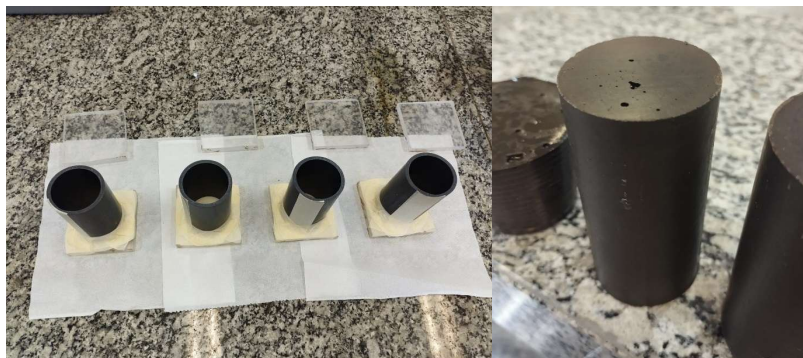
Figura 3: Moldes e corpos de prova geopoliméricos desmoldados. Fonte: Autora do trabalho.
