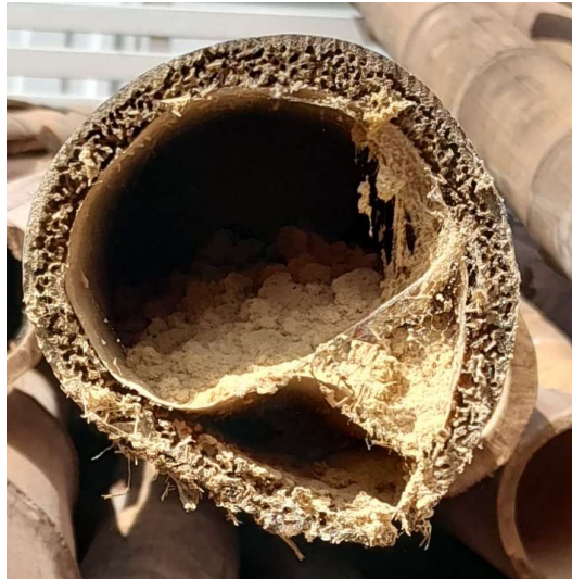
Figura 6: Peça da espécie Dendrocalamus asper descartada após ataque de coleópteros posterior às etapas de imersão no tanque de tratamento e secagem. Fonte: Autores do Trabalho.
