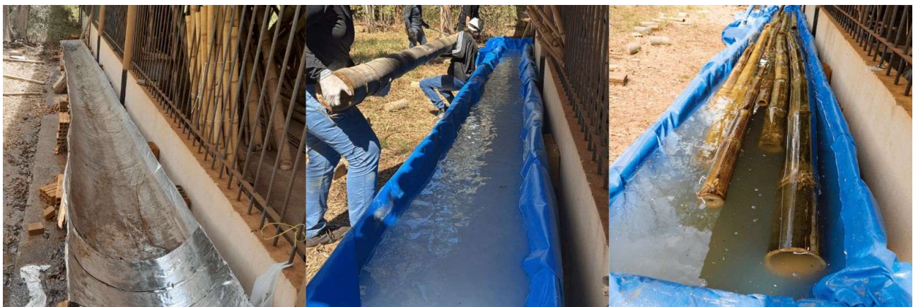
Figura 5: Registros fotográficos de dispositivo de imersão em barris soldados e lona de polietileno. Fonte: Autores do Trabalho.
