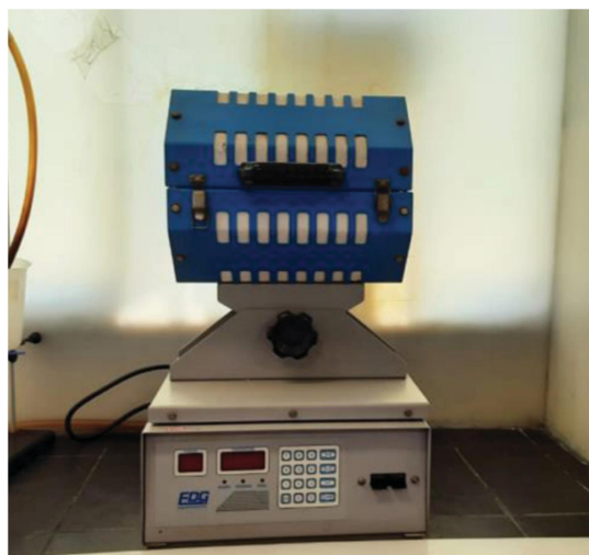
Figura 1: Forno cilíndrico utilizado na pirólise. Fonte: Rocha, 2022.
