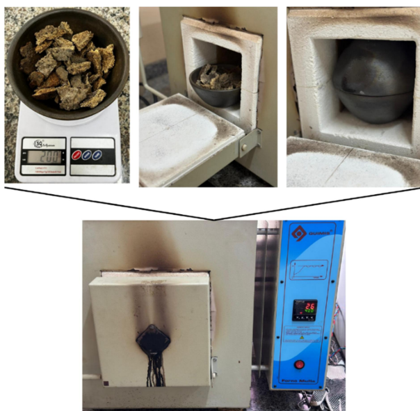
Figura 01 - Lascas De Ouriço Na Mufla Para Carbonização. Fonte: Autores do trabalho
