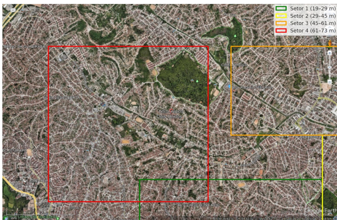
Figura 2: Divisão setorial para a coleta de resíduos sólidos urbanos no bairro Dois Unidos (Recife-PE), baseada nas características topográficas. Fonte: Os Autores (2025).
