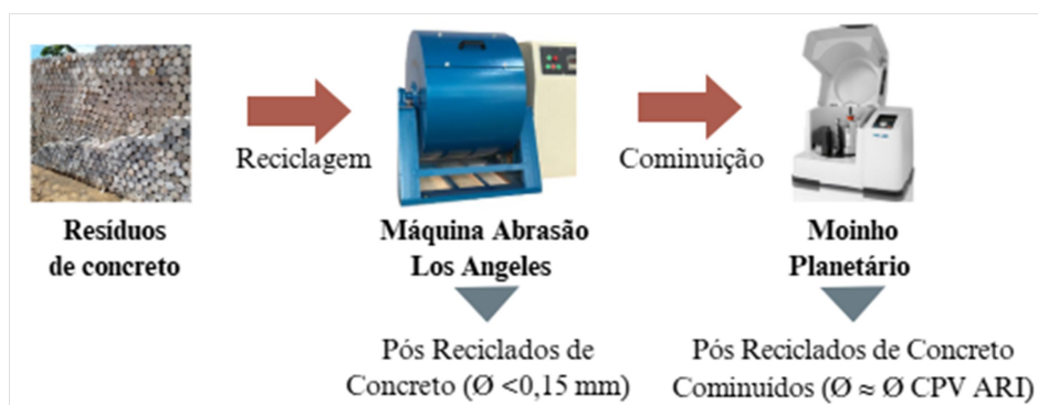
Figura 1: Processamento de moagem de resíduos de concreto. Fonte: Autores, 2025.
