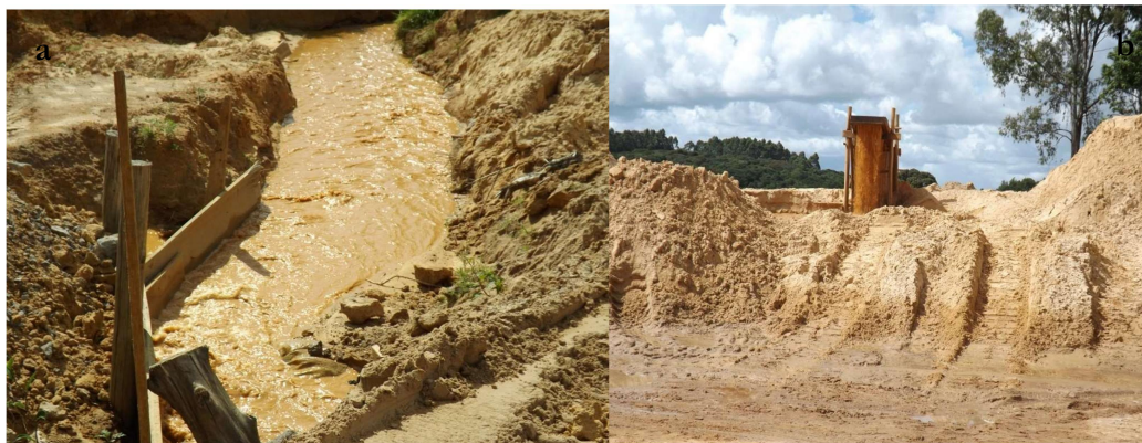
Figura 3 – Rejeitos que voltam ao tanque (a); Peneira e pilhas de areia já lavada e peneirada (b). Fonte: Autor (2023).
