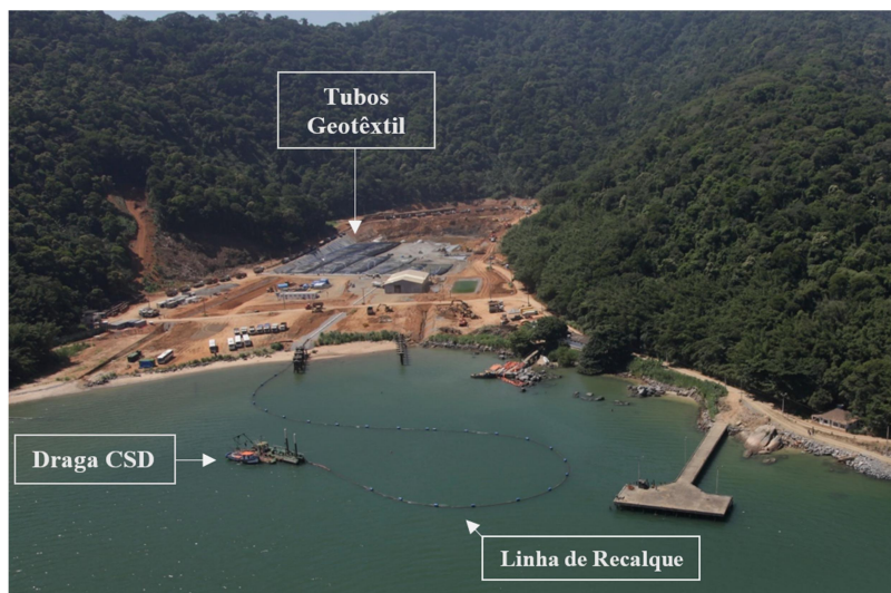
Figura 1– Fotografia aérea da draga Cutter Suction Dredger (CSD) durante a dragagem de remediação Fonte: Relatório de Monitoramento da Dragagem - EBN Itaguaí – RJ (2011).
