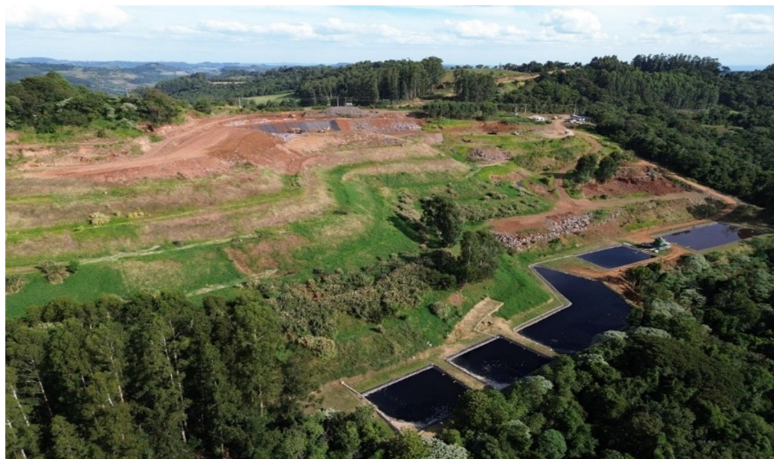
Figura 2: Vista aérea do Aterro Sanitário da empresa CRI, em Ipumirim-SC, com destaque para o sistema de cinco lagoas usado para o tratamento físico-químico. Fonte: Empresa CRI (2023).
