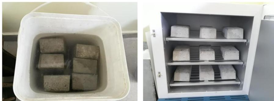
**Figura 4: Determinação da absorção de água dos pavers. Fonte: Autor do Trabalho (2022).**
