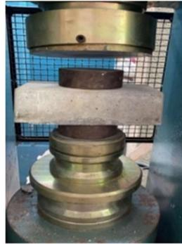
**Figura 3: Ensaio de resistência à compressão. Fonte: Autor do Trabalho (2022).**
