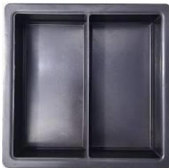
**Figura 1: Fôrmas retangulares em PVC utilizada nas moldagens. Fonte: Autor do Trabalho (2022).**
