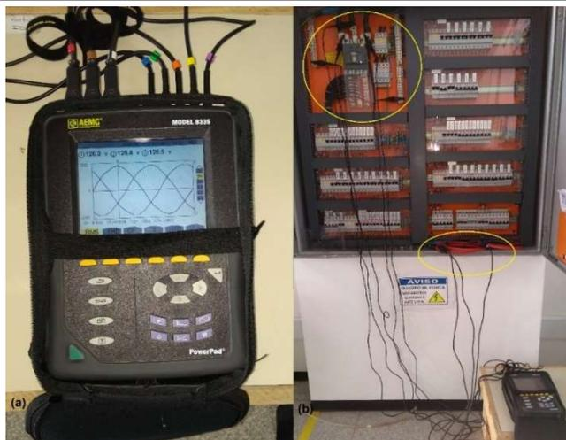
**Figura 1: Processo de medição do consumo de energia na compactação dos briquetes. (a) medidor de qualidade de energia e (b) ligação entre medidor e disjuntor da briquetadeira no quadro de força. Fonte: Autor do trabalho.**
