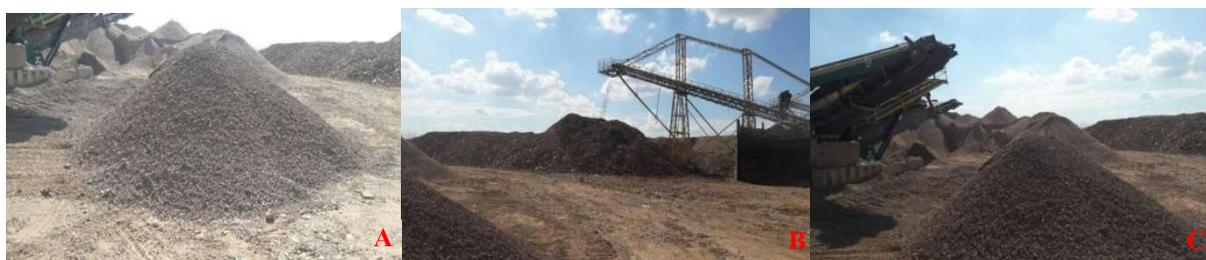
**Figura 1: RCDs selecionados para os testes de caracterização. Onde: A - Agregado Reciclado Brita 01 (RCDB1); B - Agregado Reciclado Pedrisco ou Brita 0 (RCDB0); C - Agregado Reciclado Pó de Pedra (RCDPP).**
