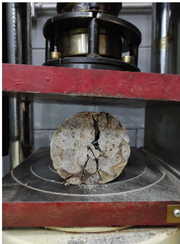
Figura 6 – Modo de ruptura do concreto no ensaio de tração indireta. Fonte: Autores do Trabalho.
