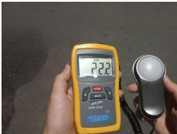
Figura 11 - Luxímetro digital modelo SKILL-TEC VICTOR 1010A utilizado nas medições de iluminância . Fonte: Ferreira, V. C. A.
