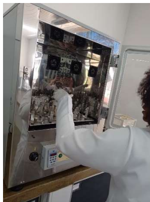
Figura 3: Encubação do teste na Estufa MARQLABOR Modelo IB-SHAKER/R. Fonte: Acervo pessoal dos autores, 2025.
