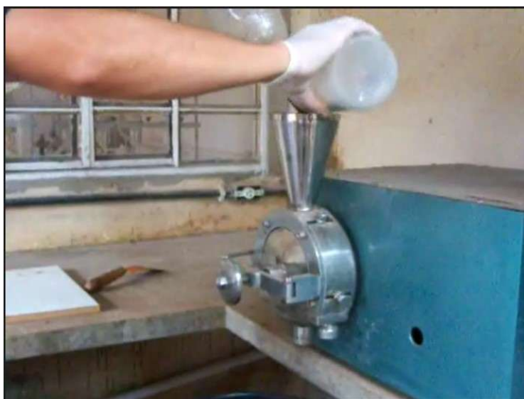
Figura 2: Moinho elétrico para reduzir a granulometria do biossólido para fins de disposição no tubete. Fonte: Autores (2025)
