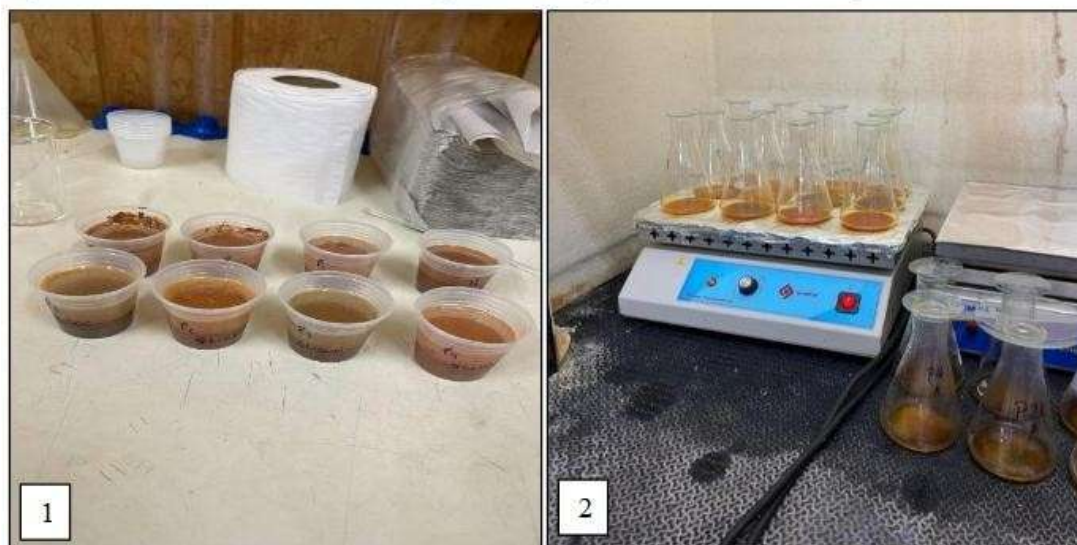
Figura 3: 1) Amostras com dicromato de potássio. 2) aquecimento das amostras para determinar a MO.
