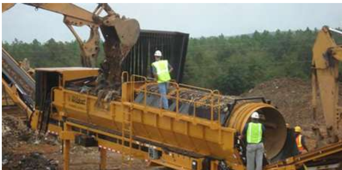
Figura 2: Uso de peneira rotativa para triagem de resíduos no aterro sanitário na Flórida (ENSIA, 2018).
