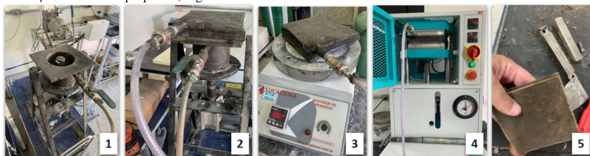
Figura 2. Etapas de confecção das placas de pedra artificial: (1) misturador; (2) moldagem com vácuo no misturador; (3) moldagem com vácuo no agitador; (4) moldagem com compactação no vácuo
