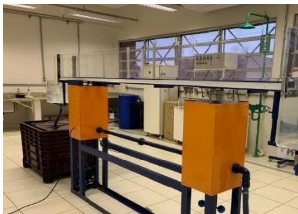
Figura 1: Canal de hidráulica de laboratório para realização dos testes iniciais e da calibração do medidor de vazão. Fonte: Autores (2021).
