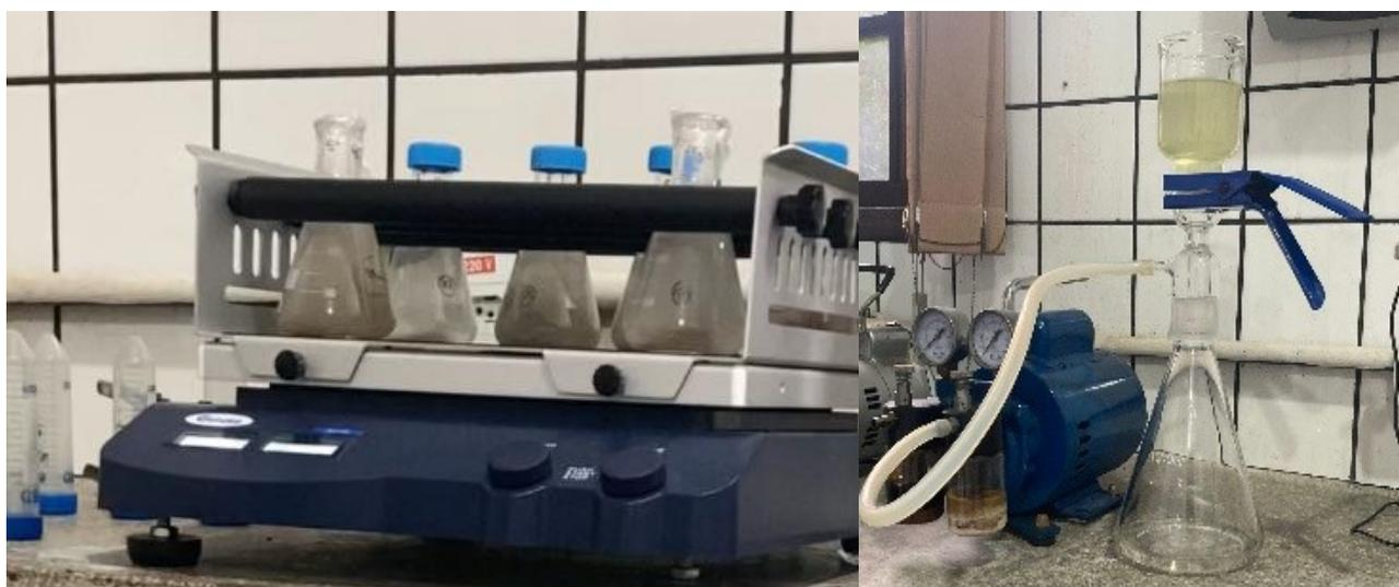
Figura 2. (a) Shaker utilizado a 450 RPM e (b) Bomba de sucção à vácuo. Fonte: Autor do trabalho.
