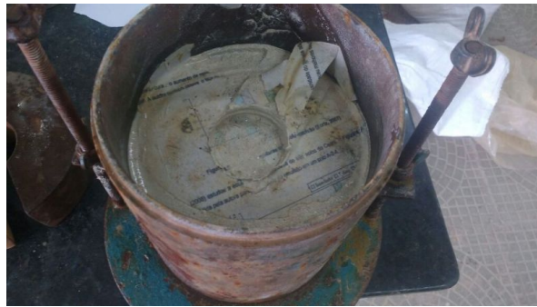
Figura 4. Resíduo do caulim após o ensaio de ISC. Fonte: Autor do Trabalho
