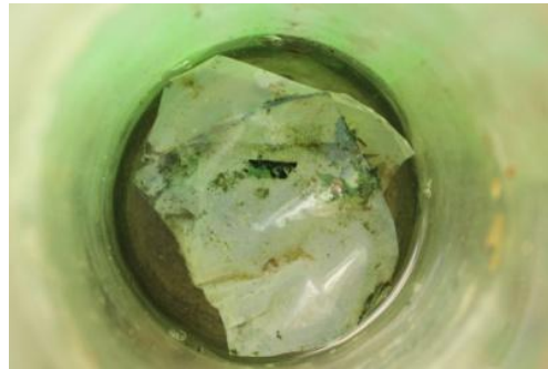
Figura 4: Fotografia feita da amostra após 3 anos exposta a água com alta carga orgânica. Fonte: Autor do trabalho.
