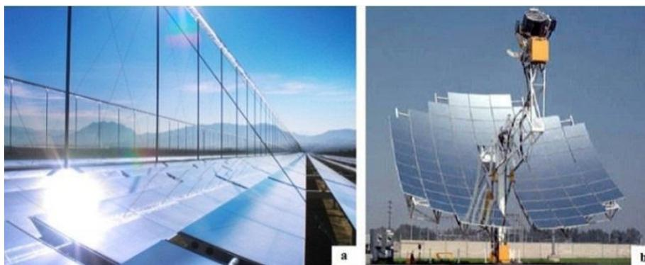
**Figura 4 – Concentrador Fresnel (a) / Concentrador Prato Parabólico (b). Fonte: NOVATEC SOLAR<sup>4</sup>.**
