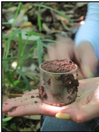
**Figura 1: Anel metálico utilizado para a coleta. Fonte: LONGO, R. M.**
