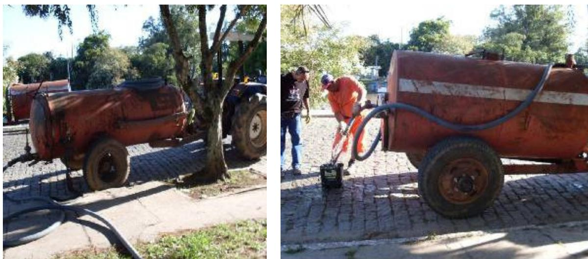
Figura 2- A esquerda Tanque sugador/aspirador de efluentes e onde os mesmos ficam armazenados antes de depositados no filtro biológico. A direita Tanque transportador de água potável. Fonte: Autor do Trabalho.
