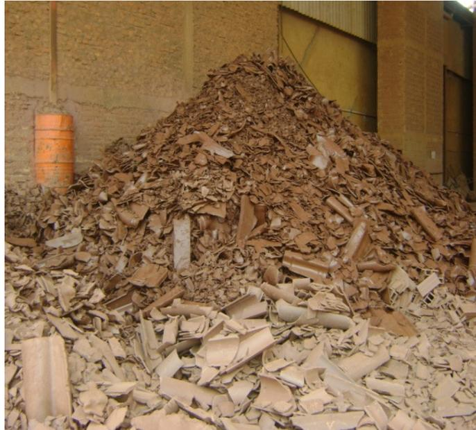
**Figura 2: Restos de cerâmicas resultantes de quebra de telhas e tijolos durante produção e armazenamento.
