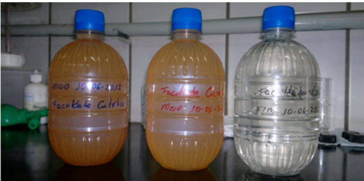
Figura 10 – Variação da turbidez da água de lavagem do filtro da ETA Anápolis/GO nas três fases da coleta.
