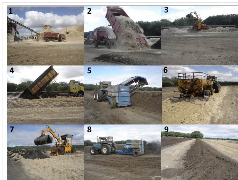
Figura 3 – Etapas do processo de produção do composto enriquecido: 1 - Carregamento do Bagaço; 2 - Formação das Leiras de Bagaço; 3 - Formação do Tapete; 4 - Descarrego da Torta; 5 - Compostador; 6 - Irrigação com Vinhaça; 7 - Montagem da Leira; 8 - Último Revolvimento; 9 - Composto Pronto.
