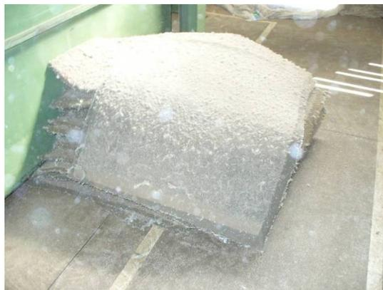
Figura 6: Manta Filtrante – Proveniente dos filtros de ar da Indústria de Fios
