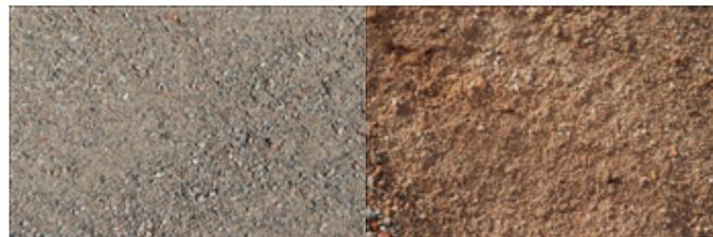
**Figura 7 – (a) Areia de concreto (b) Areia vermelha mista**
