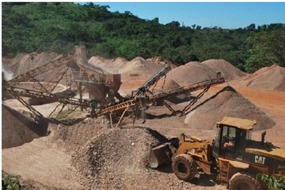
**Figura 5 – Processo de separação dos agregados por peneiramento em diferentes faixas granulométrica.**
