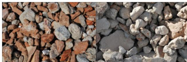
**Figura 10 – (a) Rachão (Concreto) (b) Rachão (Material Misto)**
