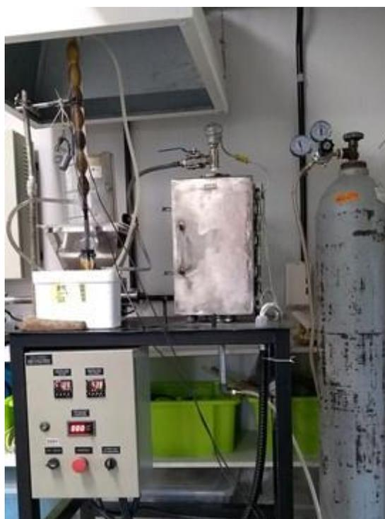
**Figura 1: Pirolisador de leito fixo utilizado para os experimentos de pirólise.**
