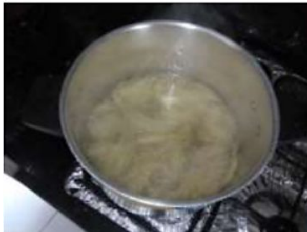
Figura 4: Lavagem das fibras na água com a temperatura de 100 °C. Fonte Carvalho, 2019.
