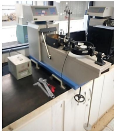
Figura 7: Equipamento cisalhamento direto. Fonte: Lopes, 2019.
