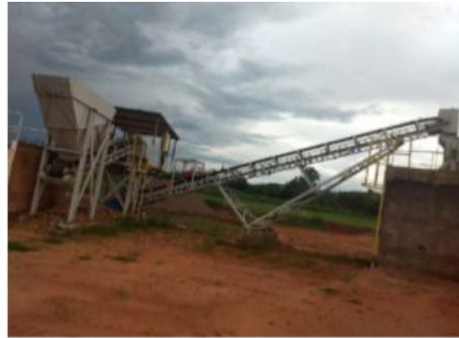
Figura2 –Britador no aterro de RCD em Santa Fé do Sul. Fonte: Autor do Trabalho.
