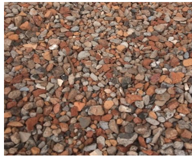
Figura 3: Resíduos da construção civil. Fonte: Autoria própria
