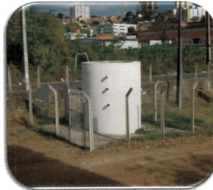
Figura 1 - Foto da Célula Experimental (Lisímetro). Fonte: Autor do Trabalho
