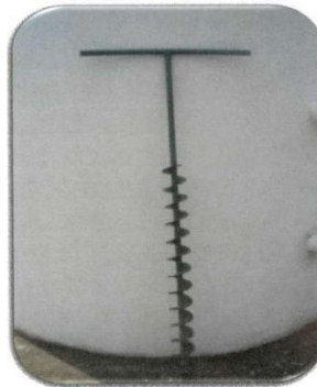
Figura 2 - Amostrador para retirada das amostras. Fonte: Autor do Trabalho
