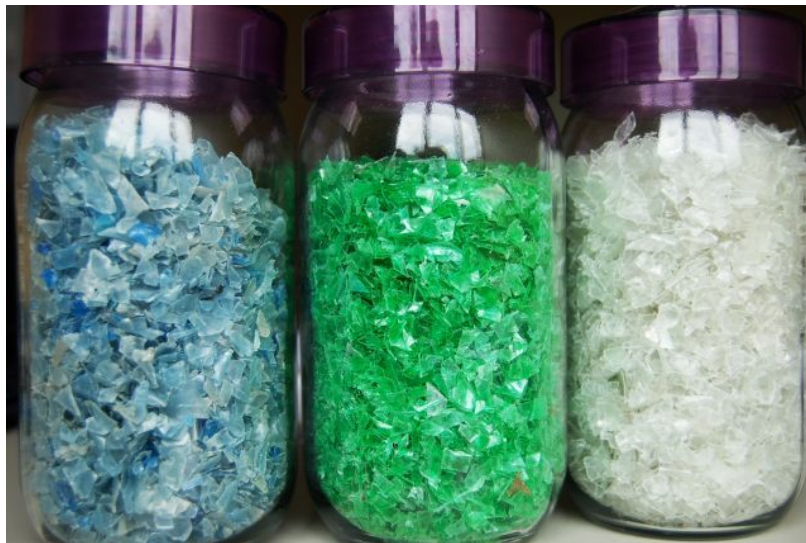
Figura 9. Produto Obtido após a Moagem – Flakes ou Flocos (Fonte: Google, 2021).
