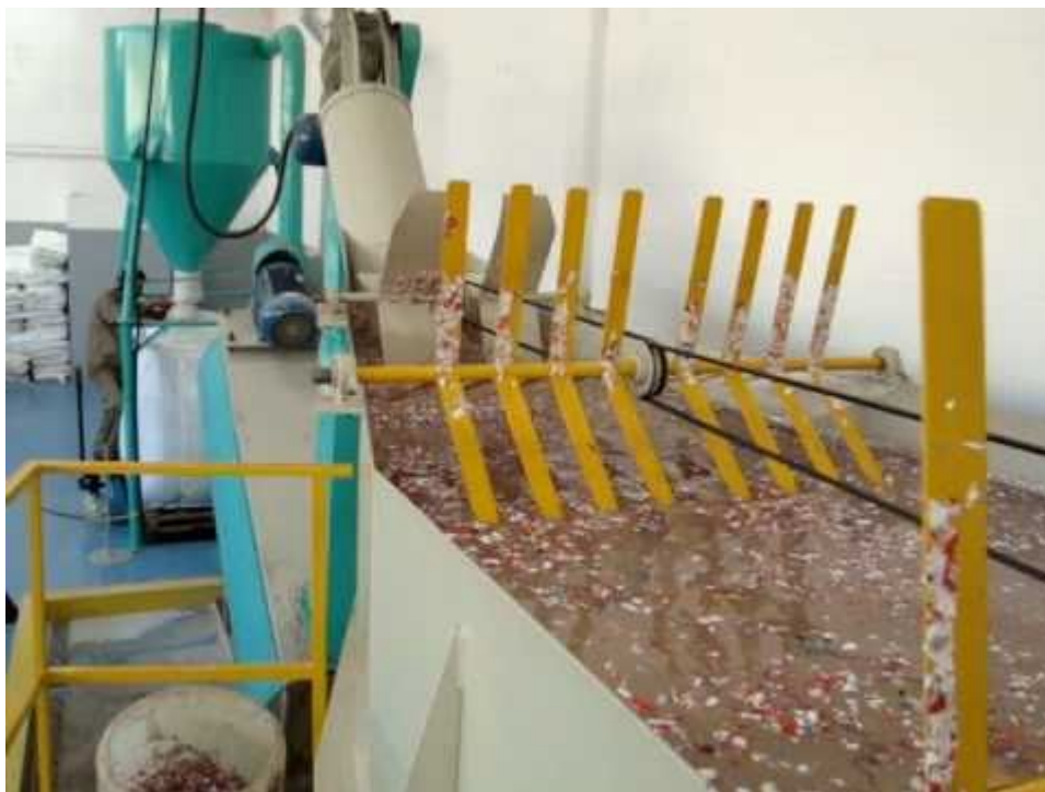
Figura 10. Banheira de Lavagem e Separação de Contaminantes (Fonte: Google, 2021).
