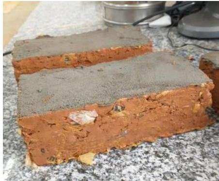
Figura 3: Blocos capeados para o ensaio de resistência à compressão simples. Fonte: Arquivo pessoal (2021).
