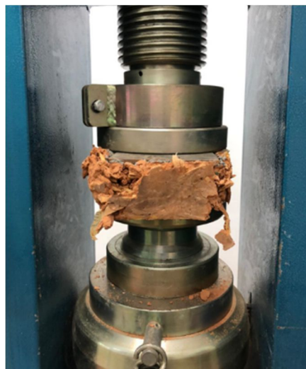
Figura 7: Bloco no estado de deformação limite. Fonte: Arquivo pessoal (2021).
