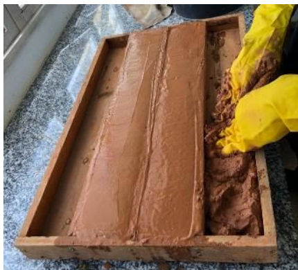
Figura 4: Disposição das misturas na caixa do ensaio de retração. Fonte: Arquivo pessoal (2021).
