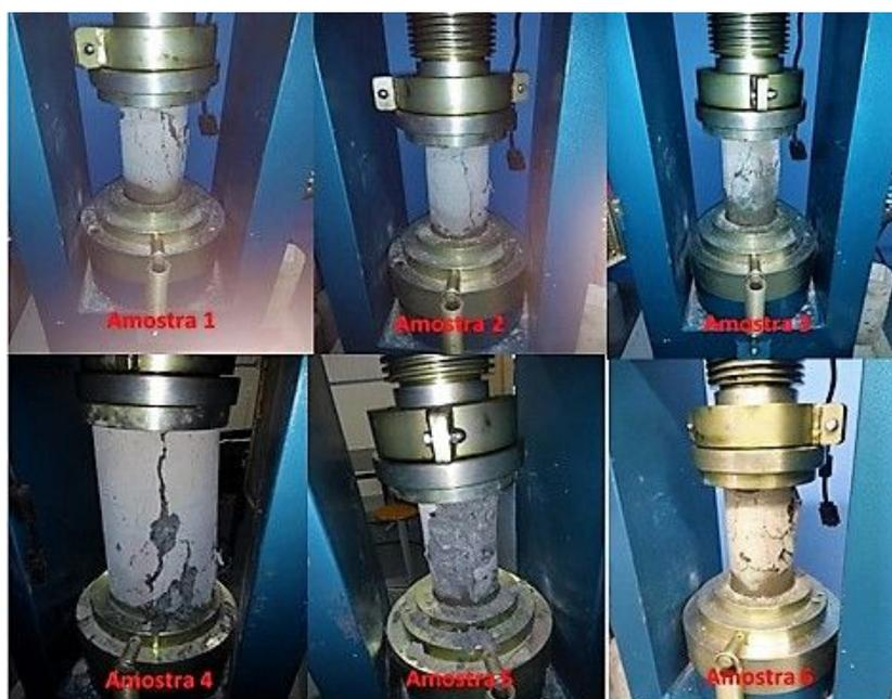
Figura 4: Traço de referncia rompido das amostras de 1 a 6 que foram preparadas com agregados reciclados.
