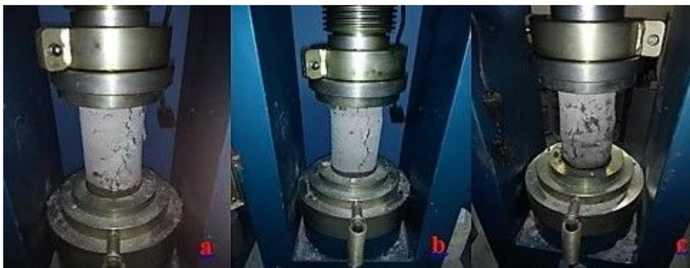
Figura 3: Traço de referência rompido das amostras 1 (a), 2 (b) e 3 (c). Fonte: Autor do Trabalho.
