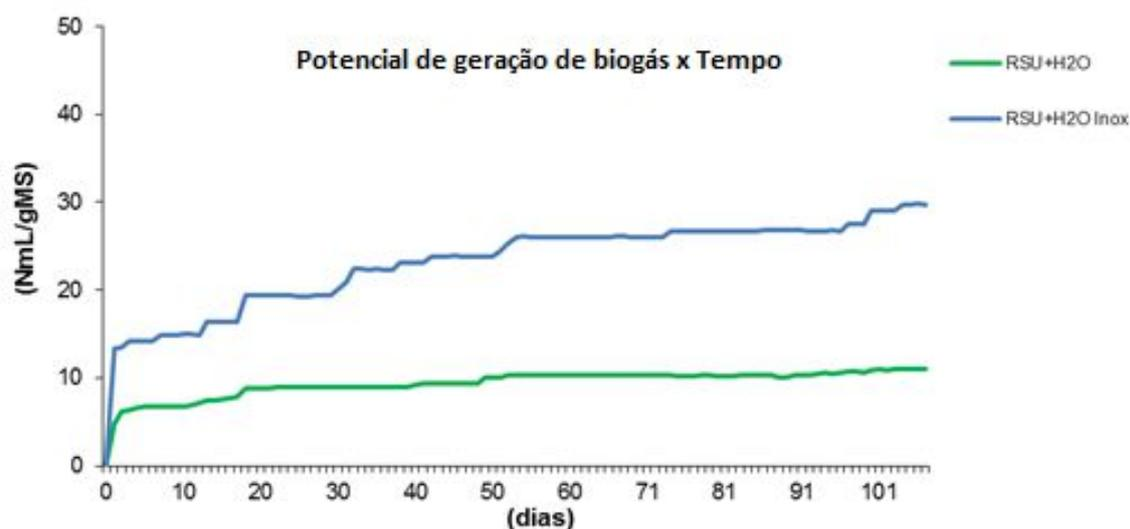
Figura 3 – Potencial de geração de biogás da amostra controle de resíduos sólidos urbanos “RSU + água” ocorrentes em biorreatores tradicionais e inox.
