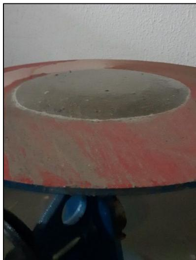
**Figura 4: Ensaio de índice de consistência**
