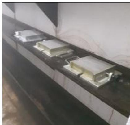
Figura 2: CPs na câmara de umidificação
