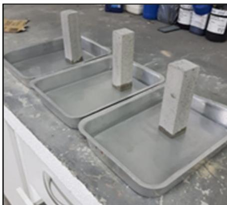
*Figura 5: Corpos de prova durante o ensaio de absorção de água por capilaridade*
