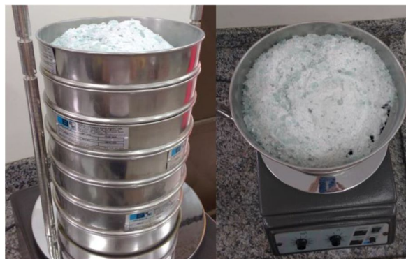
Figura 3: Material moído depositado no agitador de peneiras. Fonte: Autor do Trabalho.
