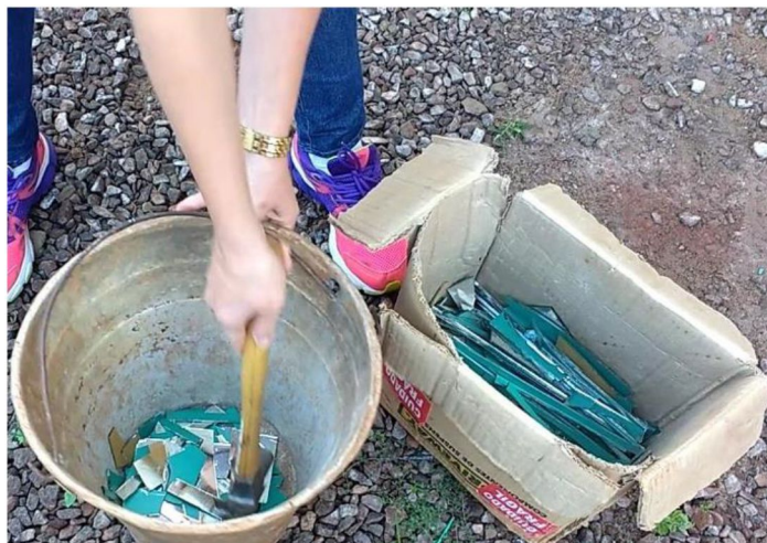
Figura 1: Material sendo pré-triturado. Fonte: Autor do Trabalho.
