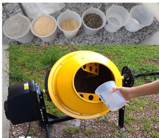
Figura 4: Materiais utilizados sendo misturados na betoneira: cimento, areia, brita, água e vidro sequencialmente. Fonte: Autor do Trabalho.
