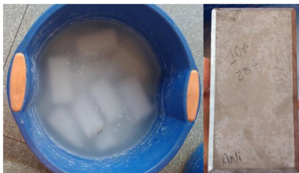
Figura 5: Pavers sendo curados nos galpões, e depois de prontos. Fonte: Autor do trabalho.
