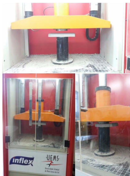
Figura 7: Prensa Hidráulica rompendo um dos corpos de prova. Fonte: Autor do Trabalho.
