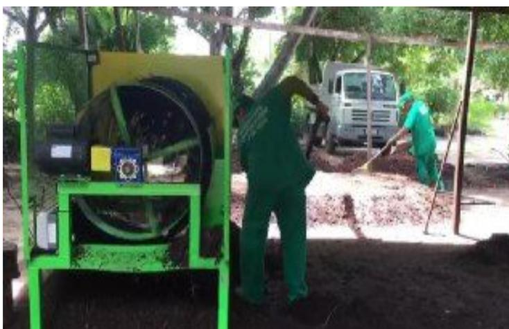
**Figura 6: Processo de separação e peneiramento: Autor do Trabalho.**
