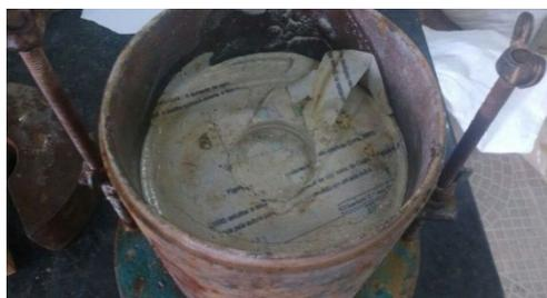
**Figura 3: Resíduo de caulim após o ensaio de ISC. Fonte: Autor do trabalho.**
