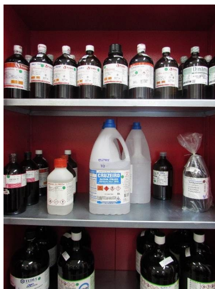
Figura 2. Identificação dos produtos químicos com etiquetas coloridas armazenados no armário de inflamáveis.
