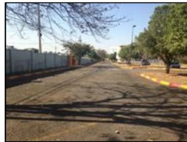
Figuras 16 e 17 - Ponto 9: Observa-se a grande área impermeabilizada e sem pontos para captação da água superficial. Detalhe para a grande rampa impermeabilizada que favorece a alta energização das águas pluviais superficiais. Foto: Sindiléia Andrade, 2017.
